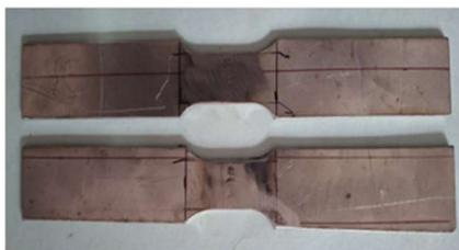
Fig 4: Before Tensile
