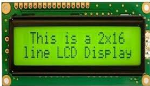
Fig 7: 16*2 LCD Display Module
